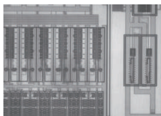
半導体ウェハー 赤外顕微鏡検査
