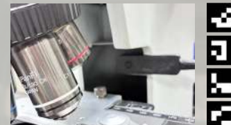
レンズに貼り付けたArucoマーカーIDを読み取り、レボルバ位置を自動検出 (特許出願中)
