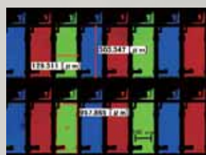
<液晶フィルター外観検査・寸法計測>
