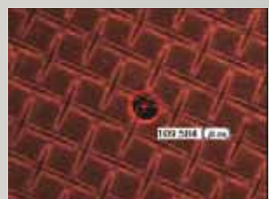
<スクリーン印刷欠陥検査 蛍光G励起>
